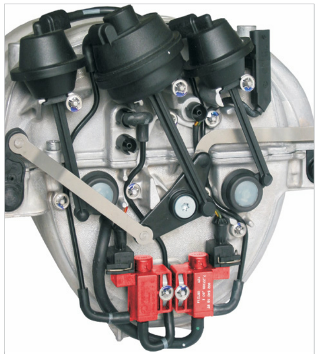
Exemple d'application : tubulure d'aspiration à résonance avec soupapes électropneumatiques (signalées en rouge) dans la Mercedes-Benz Classe C
